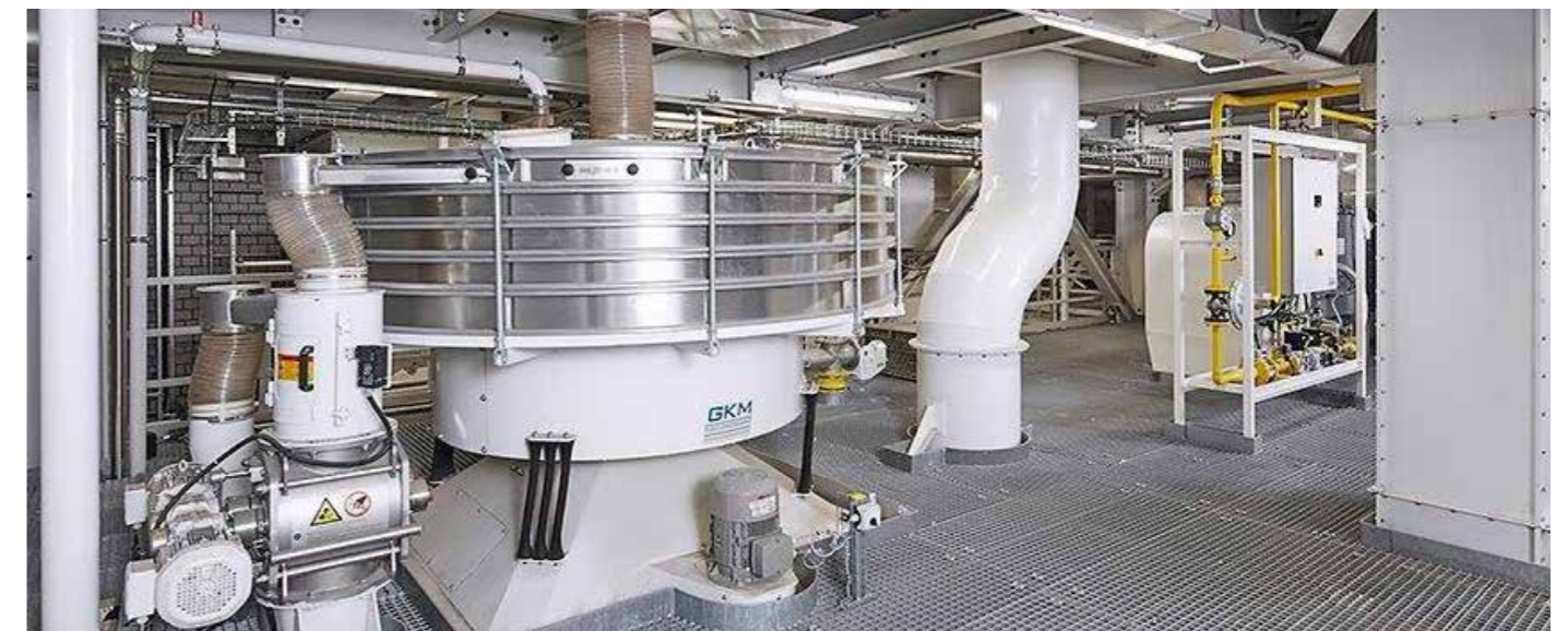
5 - Il concime, una volta essiccato, viene vagliato in modo da eliminare i granuli dalle dimensioni troppo grandi o troppo piccole per ottenere una granulometria omogenea
