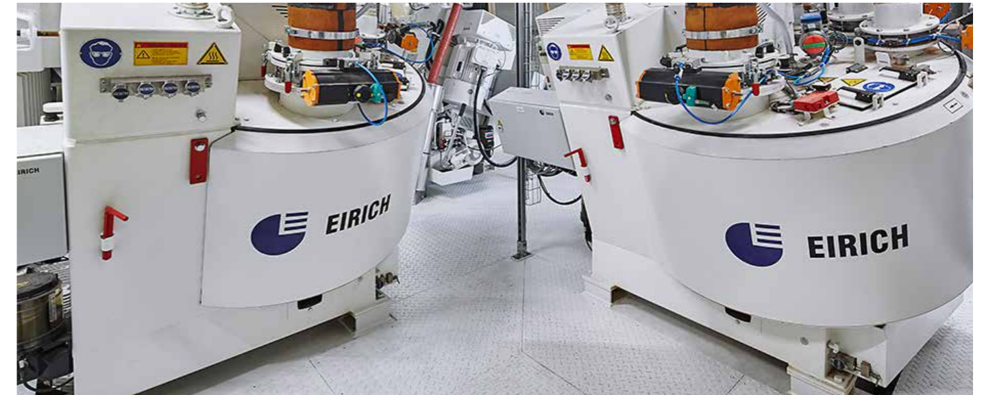
3 - Le materie prime, macinate finemente e addizionate con acqua, vengono trasformate in granuli all'interno di granulatori di ultima generazione. L'impianto è dotato di 8 unità granulatrici per garantire una produzione costante e omogenea
