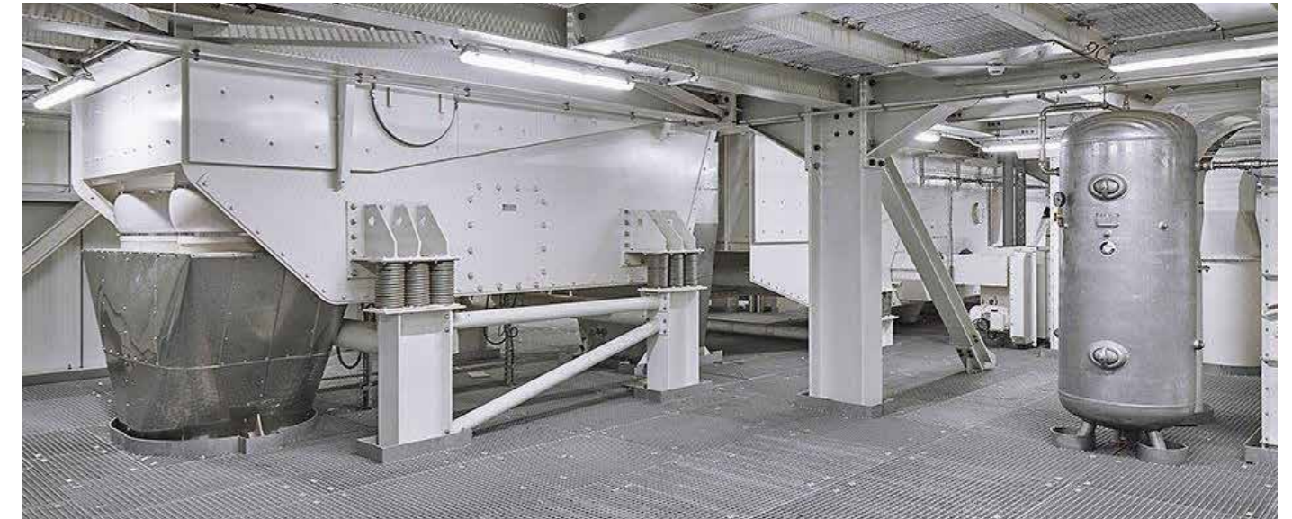
4 - Il moderno essiccatore permette di eliminare l'umidità del formulato lavorando a temperature relativamente basse assicurando così un prodotto di qualità superiore
