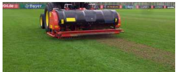
Abb. 33: Aerifiziermaßnahmen in der stark verdichteten Mittelachse
